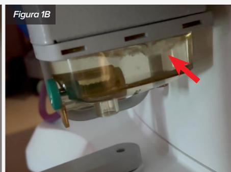
Figura 1: As figuras A e B demonstram o reservatório do condensador cheio sem ser agitado (A) e o mesmo reservatório do condensador quando agitado (B).
