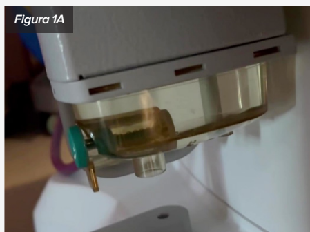
Figura 1: As figuras A e B demonstram o reservatório do condensador cheio sem ser agitado (A) e o mesmo reservatório do condensador quando agitado (B).
